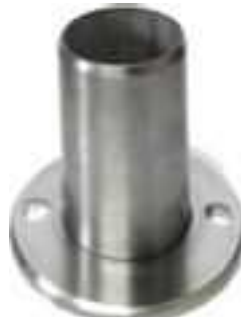
BDH-48,3 x 1,5 fixador interior com RON 80 x 5 em 304 para colar no interior do tubo 48,3 x 1,5
