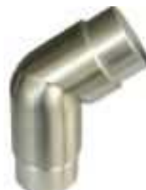
RV-1012-1014, curva regulável de 90° a 180° em inox 304 para tubo 42,4 x 2 mm
