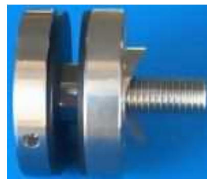
GLH-1012-50 M-12 p/ tubo 42,4 Furo mínimo no vidro de =23 MM em inox 304 ou 316
